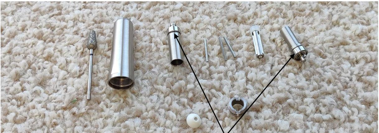
Das Handstück ist zerlegt und kann gereinigt werden. **Wichtig:** Die Lager dürfen nicht im Ultraschallbad gereinigt werden, da diese dadurch zerstört werden.
