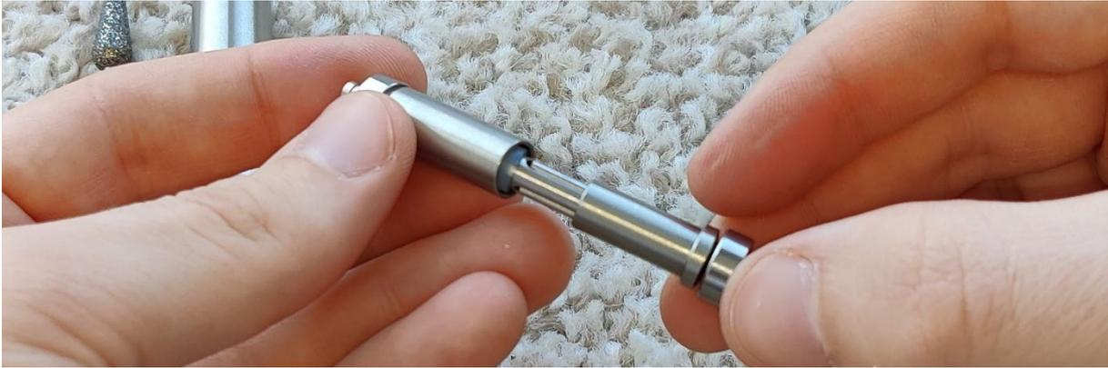
Entnehmen Sie die Schraube und die inneren Teile
