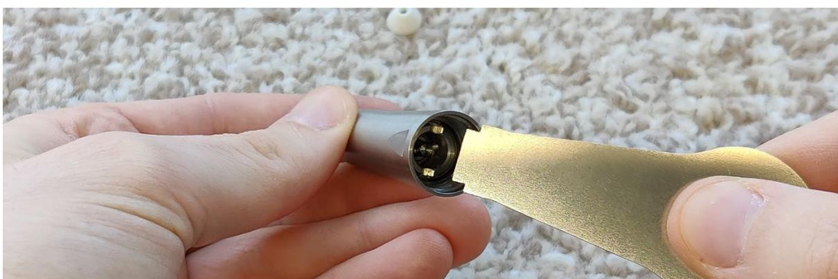
Drehen Sie die innere Schraube mit dem mitgelieferten Werkzeug auf
