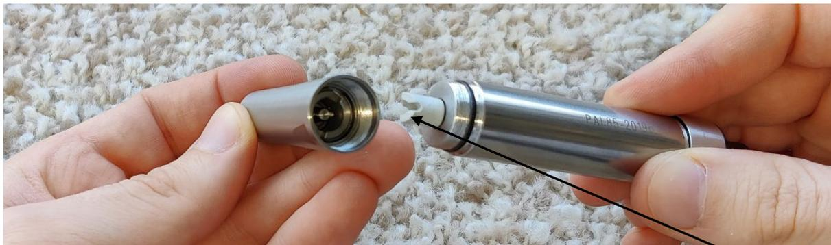
Schrauben Sie das Handstückinnenleben mit dem Motor zusammen. Achten Sie darauf, dass der Mitnehmer korrekt aufgesetzt ist.
