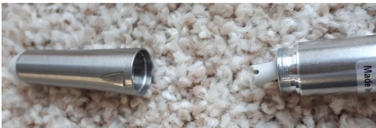
Das Handstückinnenleben kann bei Bedarf vom Motor abgeschraubt werden
