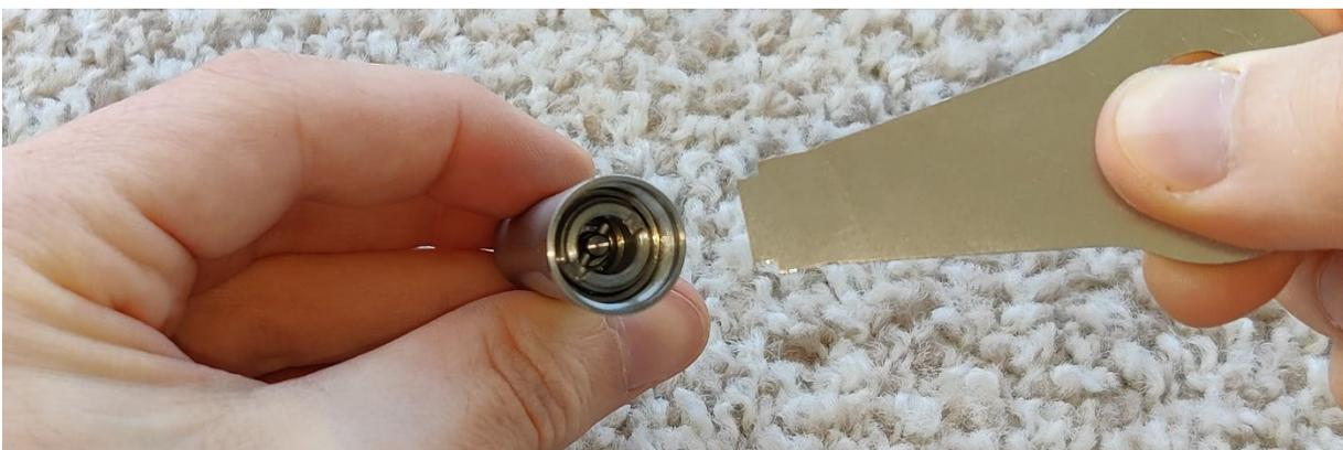
Schrauben Sie das Handstückinnenleben mit der Schraube und dem Werkzeug fest
